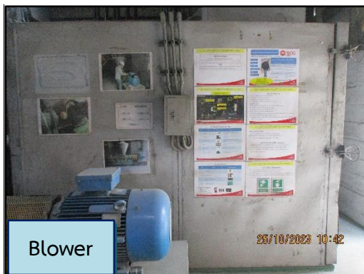
ภาพที่ 2.20 ห้องเก็บเสียงของ Blower และ Pfizer สำหรับป้องกันเสียงจากกระบวนการผลิต
