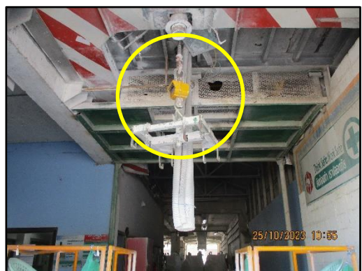
ภาพที่ 2.11 ท่อลมดูดฝุ่นขณะจ่ายปูนซีเมนต์ใส่รถเต๋า
